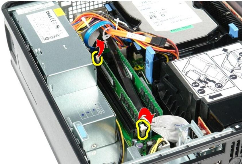
3. Levante o módulo de memória, retirando-o do respectivo conector na placa de sistema e, em seguida, remova-o do computador.
