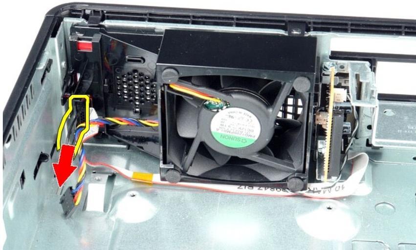
4. Pressione os grampos de retenção para soltar a ventoinha da estrutura do computador.
