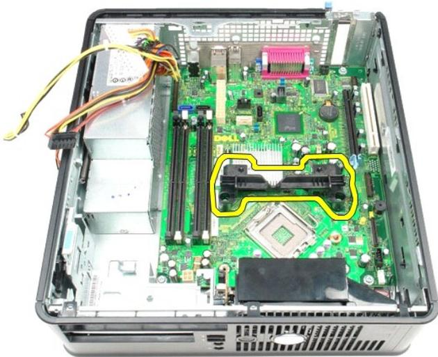
14. Remova os parafusos que fixam a placa de sistema à estrutura do computador.
