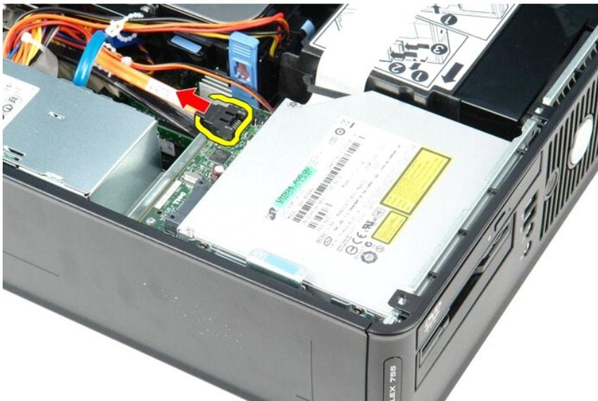
4. Puxe o trinco de desbloqueio da unidade para cima e faça deslizar a unidade óptica na direcção da parte posterior do computador.
