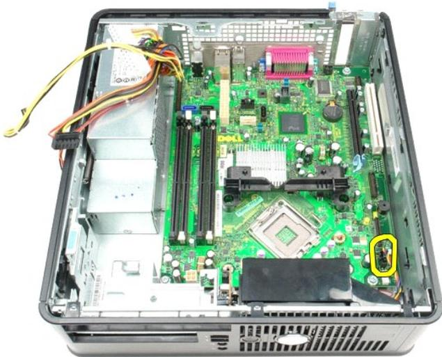
12. Remova os parafusos que fixam o módulo de fixação do dissipador de calor à placa de sistema.
